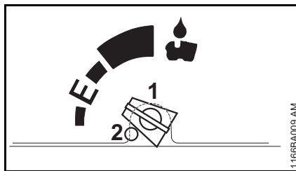
С помощью регулировочного болта (1) (на нижней стороне агрегата) регулируется необходимое количество подаваемого масла.
