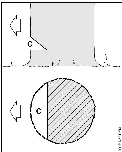
Подпил (С) определяет направление валки дерева.
