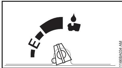
Необходимы учащенная проверка и дозаправка масляного бака, – см. "Регулировка подачи масла".
