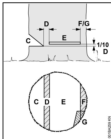
Подпил (C) определяет направление валки дерева.
