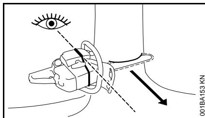
Данная бензопила предусмотрена с валовой планкой на кожухе о корпусе вентилятора. Использовать данную валовую планку.
