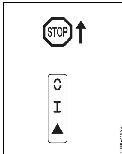
STOP либо **0** – для выключения зажигания комбинированный рычаг следует нажать в направлении STOP либо **0**. После освобождения комбинированный рычаг отпружинивает в рабочее положение **I**.
