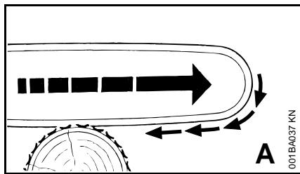
Если при пилении нижней стороной направляющей шины – передний рез – цепь защемляется или наталкивается на твердый предмет в древесине, то пила может быть отброшена в сторону пользователя – **во избежание этого:**
