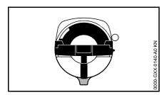
В этом случае будут совпадать маркировки на крышке бака и на топпивном баке
