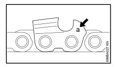
Обозначение (**a**) шага цепи выгравировано в области ограничителя глубины реза каждого режущего зуба.
