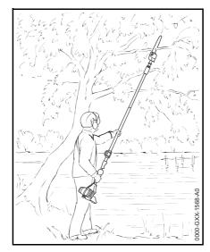
Благодаря большому радиусу действия можно обрезать сучья над препятствиями, такими как, например, водоёмы. Угол установки зависит от положения сучка.
