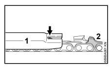
На пильную цепь наложить опиловочный шаблон (1), соответствующий шагу пильной цепи и прижать на режущем зубе подлежащем проверке - если ограничитель глубины выступает над шаблоном, то ограничитель должен быть дополнительно обработан
