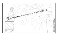
Благодаря большому радиусу действия можно резать сучья непосредственно на стволе, при этом без повреждения других сучьев
