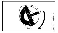
Запорное устройство бака держать нажатым и одновременно поворачивать по часовой стрелке, пока оно не зафиксируется
