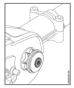
Звёздочка цепи приводится в действие через проскальзывающую муфту. Замена звездочки цепи должна производиться специализированным дилером.
