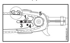
Направляющую шину через болт (3) и фиксирующее отверстие (4) уложить над цапфой на пружинной задвижке – в то же время пильную цепь уложить над цепной звёздочкой (5)
