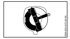
Маркировки на крышке бака и топливном баке должны совпадать
