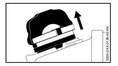
• Снять крышку топливного бака
