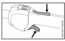
Нажать фиксатор рычага акселератора и дать газ − рычаг воздушной заслонки перескакивает в рабочее положение I − после запуска в холодном состоянии прогреть двигатель, несколько раз изменяя нагрузку
