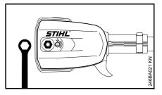
Отвернуть гайку и снять крышку цепной звездочки
