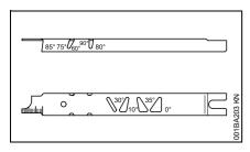
Пользоваться опиловочным шаблоном STIHL (специальные принадлежности, см. таблицу "Инструменты для заточки") — универсальный инструмент для контроля угла заточки и переднего угла, высоты ограничителя глубины, длины зуба, глубины паза и для очистки пазов и впускных масляных отверстий.
