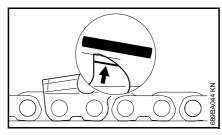
В заключение дополнительно опилить ограничитель глубины резки под наклоном, параллельно нанесенной сервисной маркировке (см. стрелку) - при этом, следить за тем, чтобы не сместить назад наивысшую точку ограничителя глубины
