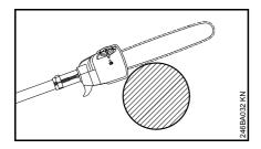
При подпиле шину привести в область крючка на сучке до прилегания. Это поможет избежать обратных движений мотоустройства во время начала продольной распиловки.
