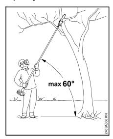
Мотоустройство держать под наклоном, не стоять непосредственно под отпиливаемым сучком. Не превышать угол 60° к горизонтали. Обращать внимание на падающую вниз древесину.
