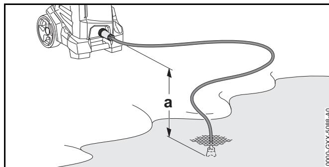
Чтобы обеспечить засасывание воды, разность по высоте между мойкой высокого давления и источником воды не должна превышать максимальную высоту всасывания (a), 19.1.
