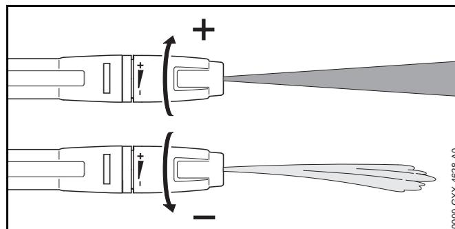
Плоскоструйную насадку можно регулировать.
