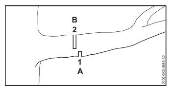
Сначала сделать компенсационный подпил (1) со стороны действия сил сжатия (A), затем пропил (2), сдвинутый в направлении ствола, со стороны действия сил растяжения (B).
