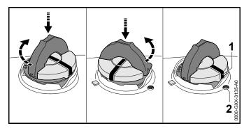
► Прижать крышку масляного бака книзу и повернуть до упора по часовой стрелке.
