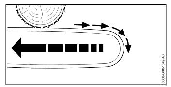
При пилении верхней стороной направляющей шины мотопила может быть отброшена в направлении пользователя.
