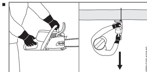
При отдаче возможно отбрасывание мотопилы в сторону пользователя. Пользователь может потерять контроль над мотопилой и получить тяжелые или смертельные травмы.
