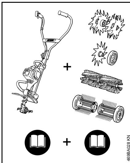
El sistema MultiSystem de STIHL, permite combinar diversos motores MultiEngine y accesorios MultiTool para formar una máquina. En el presente Manual de instrucciones, la unidad funcional compuesta por el motor MultiEngine y el accesorio MultiTool se denomina la máquina.
