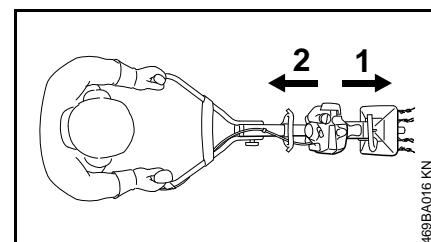
El motor MultiEngine con cuchillas giratorias puede ponerse en marcha en sentido de avance (1) o retroceso (2).
