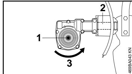
Eje de salida (1) de caja de engranajes debajo del tubo de mando (2).
