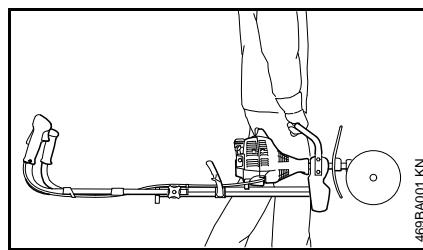
Sujete la herramienta motorizada por su argolla de transporte, con el accesorio hacia delante.
