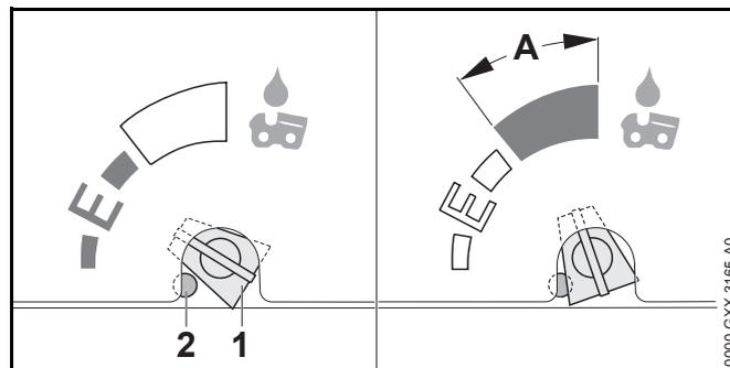
Положение E (Ematic) регулировочного винта (1) масляного насоса обеспечивает оптимальную подачу масла для большинства режимов эксплуатации.
