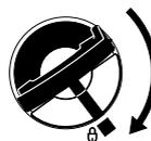
Правильно установить крышку бака с откидным хомутиком (байонетный затвор), повернуть до упора и захлопнуть хомутик.
