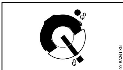
Запорное устройство бака зафиксировано
