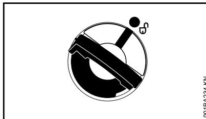
Маркировки на запорном устройстве бака и на топливном баке должны совпадать
