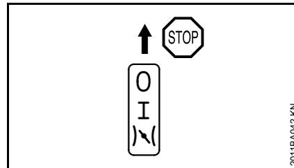
**STOP-0** – двигатель остановлен – зажигание выключено
